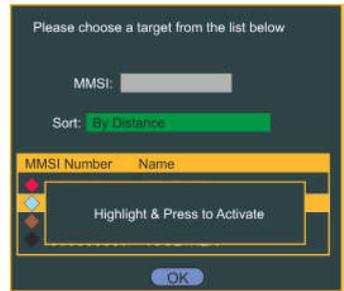
Al introducir cualquier dispositivo AIS MOB, el ATA100 se configurará como "Man Overboard Alarm", que hará sonar una advertencia audible y/o activará el relé incorporado para activar un indicador de terceros o una Alarma .
