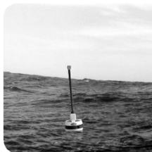
In caso di affondamento dell'imbarcazione, l'EPIRB1 Pro si sgancerà automaticamente dalla custodia ed emergerà in superficie. L'EPIRB1 Pro si attiverà automaticamente al contatto con l'acqua.
