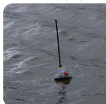
En cas de naufrage, la balise EPIRB3 Pro est automatiquement larguée de son conteneur et flotte à la surface de l'eau. Au contact de l'eau l'EPIRB3 Pro est automatiquement activée.
