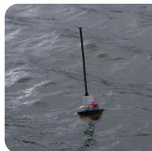
En caso de hundimiento la EPIRB3 Pro se liberará automáticamente de su carcasa y flotará a la superficie. El contacto con el agua activa automáticamente la EPIRB3 Pro.
