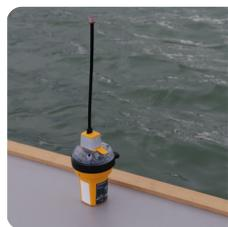
Al activar la EPIRB3 Pro en cubierta, asegurarse de que esté en posición vertical y libre de obstrucciones que puedan impedir una visión clara del cielo. Si se lanza al agua la unidad, se activará automáticamente.
